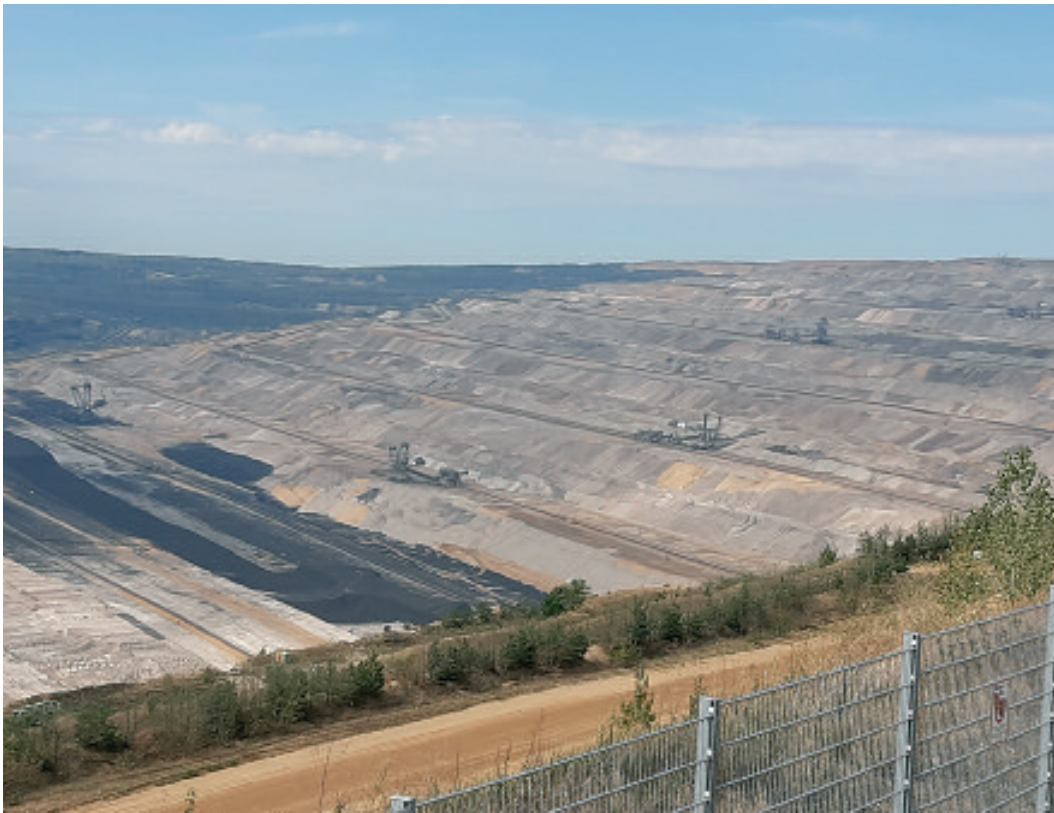
Tagebau Hambach mit der Kohlensohle und dem Fuß der Innenkippe, wo die Erdmassen unsortiert abgekippt werden.
